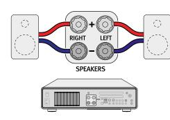
Veillez à raccorder correctement le câble des enceintes aux bornes de l'appareil.
