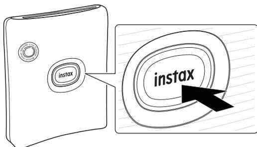
Maintenez le bouton d'alimentation enfoncé pendant environ 1 seconde pour mettre l'imprimante sous ou hors tension. Le voyant DEL s'allume lorsque l'imprimante est mise sous tension. Si l'imprimante reste inactive sans fonctionner pendant 5 minutes, elle s'éteint automatiquement.
