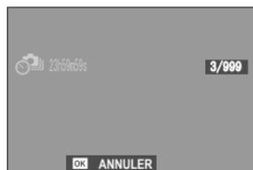
❗ La photographie par minuterie d'intervalle ne peut pas être utilisée à une vitesse d'obturation de "bulb" ou avec la photographie à expositions multiples. En mode rafale, une seule photo est prise à chaque déclenchement de l'obturateur.
