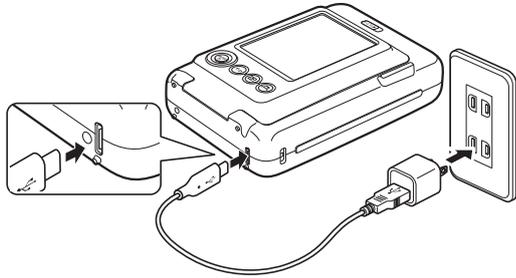
Connectez l'appareil photo et un adaptateur CA USB fourni avec votre smartphone à l'aide du câble USB de type C fourni, puis connectez l'adaptateur CA USB à une prise secteur intérieure.
