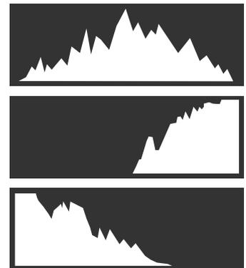
Pour afficher des histogrammes RVB distincts et les zones de l'image surexposées avec les réglages en cours, en superposition de la vue passant par l'objectif, appuyez sur la touche de fonction à laquelle l'option **HISTOGRAMME** est attribuée.
