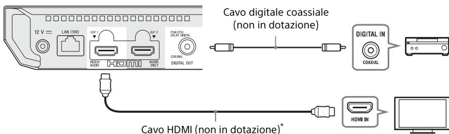
\* Cavo HDMI ad alta velocità di qualità superiore o cavo HDMI ad alta velocità che supporti una larghezza di banda di 18 Gbps.
