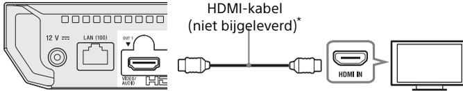
\* Premium high speed HDMI-kabel of een High Speed HDMI-kabel die een bandbreedte van 18 Gbps ondersteunt.
