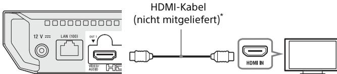
\* Premium Hochgeschwindigkeits-HDMI-Kabel oder High-Speed-HDMI-Kabel mit Unterstützung der 18 Gbit/s-Bandbreite.
