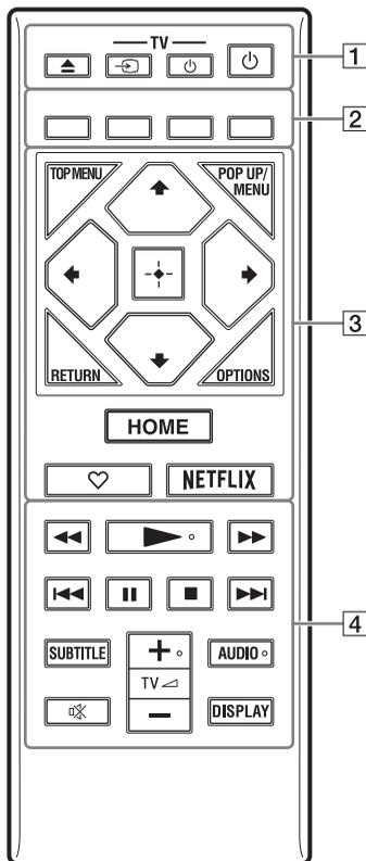
☛, TV  $\triangleleft$  + e AUDIO sono dotati di un punto a sfioramento. Usare il punto a sfioramento come riferimento quando si aziona il lettore.
