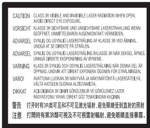
Deze sticker bevindt zich op de laserafscherming in de behuizing.
