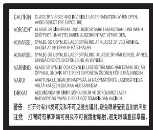
Questa etichetta si trova sull'alloggiamento di protezione dai raggi laser all'interno del rivestimento.
