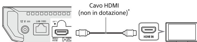
\* Cavo HDMI ad alta velocità di qualità superiore o cavo HDMI ad alta velocità che supporti una larghezza di banda di 18 Gbps.
