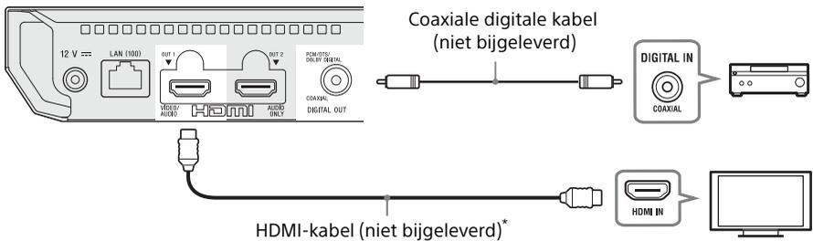
\* Premium high speed HDMI-kabel of een High Speed HDMI-kabel die een bandbreedte van 18 Gbps ondersteunt.
