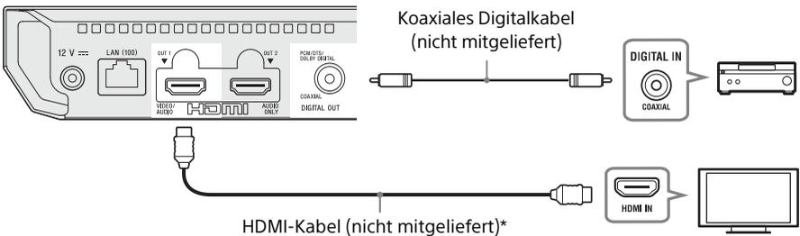
\* Premium Hochgeschwindigkeits-HDMI-Kabel oder High-Speed-HDMI-Kabel mit Unterstützung der 18 Gbit/s-Bandbreite.
