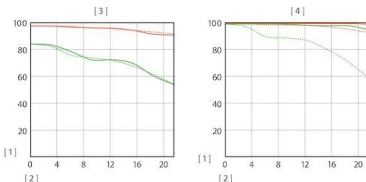
[1] Contraste (%) [2] Distance du centre optique de l'objectif (mm)
