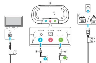
Branchez la base émettrice au téléviseur en utilisant le câble n°3 fournis
