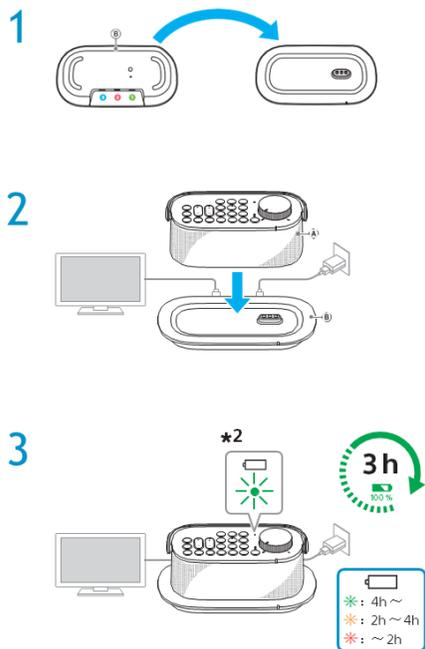
Il suffit de poser l'enceinte sur la base émettrice pour commencer à la charger.
