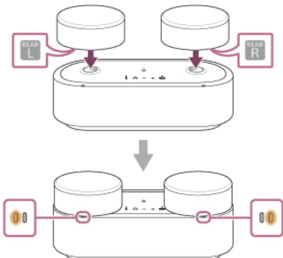
Placez l'enceinte arrière (L) sur le côté gauche et l'enceinte arrière (R) sur le côté droit. Vous pouvez vérifier l'emplacement des enceintes arrière gauche et droite grâce aux étiquettes présentes sur le dessous des enceintes arrière.
