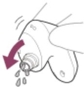
3. Orientez le micro ou le trou d'aération vers le bas et tapotez légèrement à 20 reprises environ au-dessus d'un chiffon sec ou autre pour évacuer l'eau éventuellement présente à l'intérieur.
