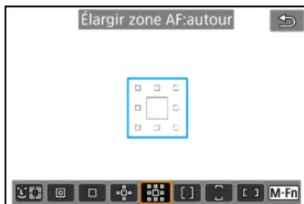
La mise au point utilise un collimateur AF (☒) et les collimateurs AF environnants entourés ici en bleu, ce qui rend plus facile la mise au point sur les sujets en mouvement qu'avec Élargir zone AF : ☒☒. L'opération AF Servo est la même que pour Élargir zone AF : ☒☒.
