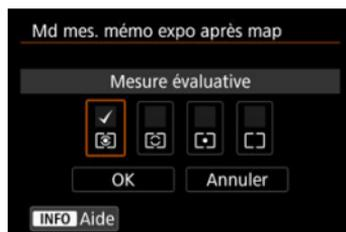
Pour chaque mode de mesure, vous pouvez spécifier de verrouiller ou non l'exposition (mémorisation d'exposition) une fois que les sujets sont nets avec Autofocus One-Shot. L'exposition est verrouillée pendant que vous maintenez enfoncé le déclencheur à mi-course. Sélectionnez les modes de mesure pour la mémorisation d'exposition et cochez [✓]. Sélectionnez [OK] pour enregistrer le réglage.
