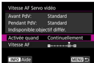
Vous pouvez régler [**Continuellement**] pour que la vitesse de l'autofocus soit tout le temps active pour l'enregistrement vidéo (avant et pendant l'enregistrement vidéo) ou régler [**Pendant la PdV**] pour que la vitesse de l'autofocus ne soit active que pendant l'enregistrement vidéo.
