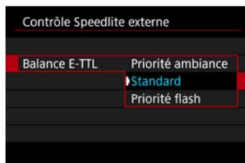
Vous pouvez régler votre apparence préférée (balance) pour les prises de vue avec flash. Ce réglage vous permet d'ajuster le ratio de l'éclairage ambiant sur la sortie lumineuse du flash Speedlite.
