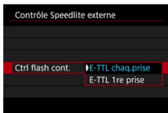
Réglez sur **[E-TTL chaq.prise]** pour exécuter la mesure du flash pour chaque prise. Réglez sur **[E-TTL 1re prise]** pour exécuter la mesure du flash pour la première prise uniquement avant la prise de vue en continu. Le niveau de puissance du flash pour la première prise est appliqué à toutes les photos ultérieures. Pratique pour donner la priorité à la vitesse de la prise de vue en continu sans recadrer les photos.
