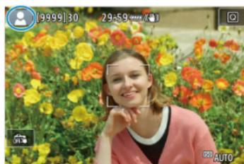
L'appareil photo détecte le type de scène et règle tout automatiquement selon la scène. Le type de scène détecté est indiqué dans le coin supérieur gauche de l'écran. Voir [Icônes de scène](#) pour en savoir plus sur les icônes.
