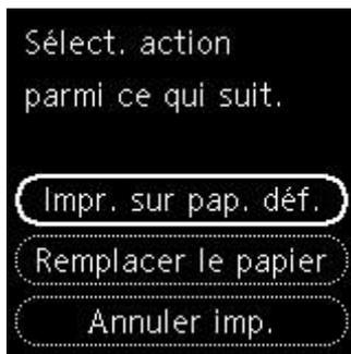
Utilisez les boutons ▲ ▼ pour sélectionner l'action appropriée et appuyez sur le bouton **OK** de l'imprimante.
