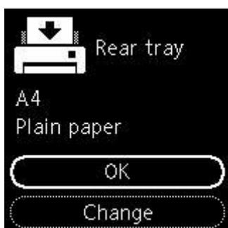
Si le format de page sur l'écranLCD correspond au format de papier chargé dans le réceptacle arrière, sélectionnez **OK**.
