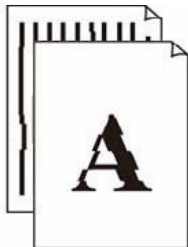
Les lignes sont mal alignées/déformées
