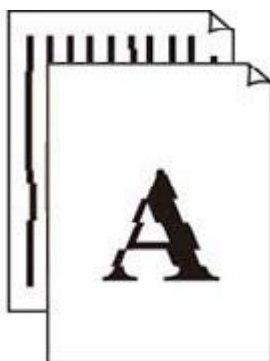
Les lignes sont mal alignées/déformées
