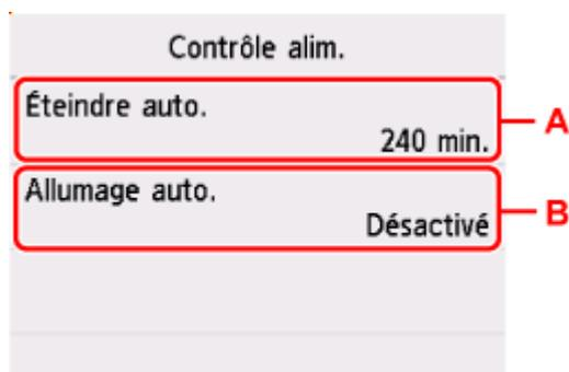
A: Spécifiez la durée au terme de laquelle l'imprimante se met automatiquement hors tension lorsqu'aucune opération n'est exécutée ou qu'aucune donnée d'impression n'est envoyée à l'imprimante.
