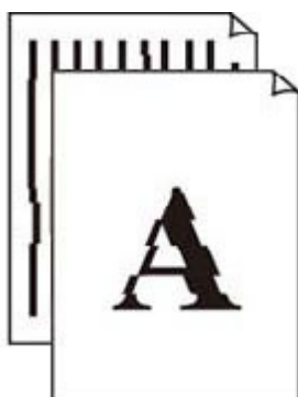
Les lignes sont mal alignées/déformées
