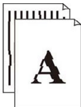
Les lignes sont mal alignées/déformées
