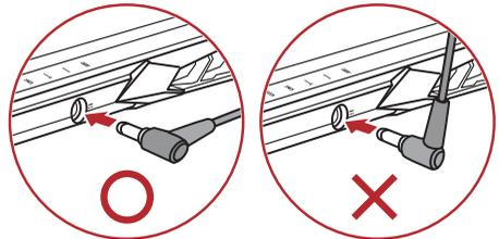
**Remarque :** Veuillez enfoncer l'adaptateur secteur dans le tunnel jusqu'au connecteur d'alimentation. Vous sentirez un clic indiquant qu'il est connecté. Ensuite, vérifiez que le témoin de la batterie est orange pendant la charge.
