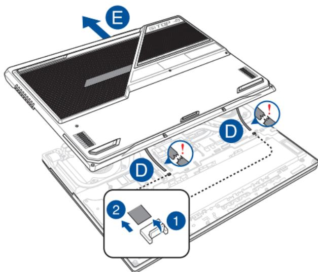
Pour reconnecter le(s) câble(s) à l'arrière du couvercle du compartiment, suivez les étapes ci-dessous pour retirer d'abord le(s) circuit(s) imprimé(s), puis reconnectez le(s) câble(s) avant de réinstaller le(s) circuit(s) imprimé(s).
