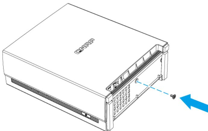
d. Placez l'appareil dans sa position verticale normale.
