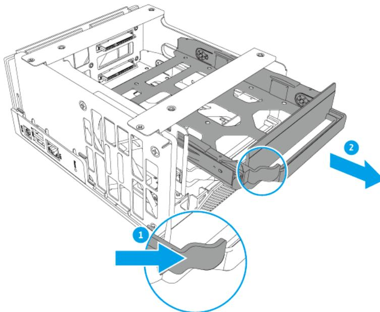
b. Retirez les panneaux de fixation sur les côtés du plateau de disque.
