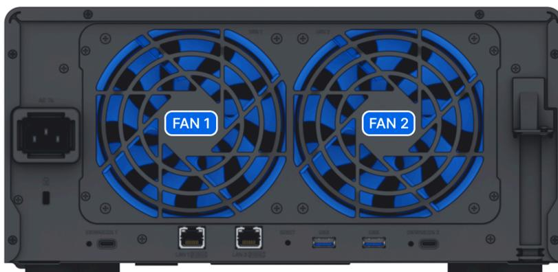
3. Retirez les vis fixant le couvercle du ventilateur à l'arrière de votre Synology NAS.
