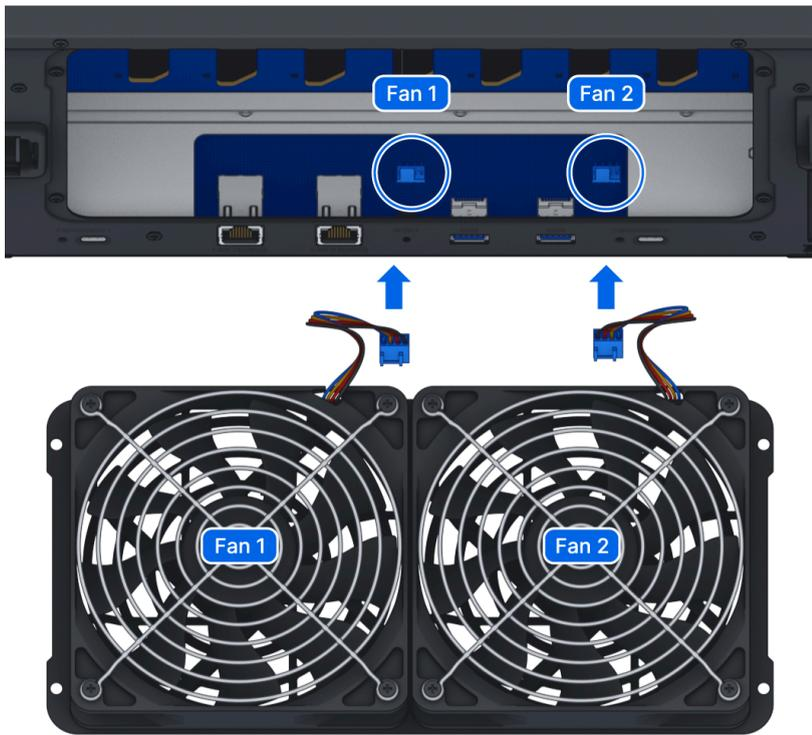
6. Retirez le couvercle du ventilateur du châssis.
