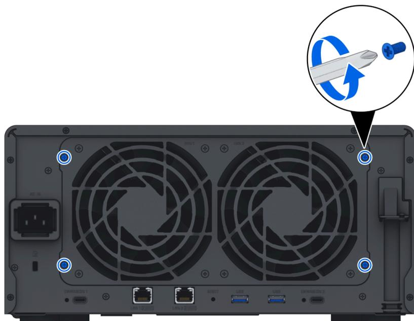
4. Retirez le couvercle du ventilateur du châssis.
