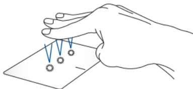
Appuyez rapidement sur le pavé tactile avec trois doigts pour lancer la fonction que vous avez sélectionnée dans Paramètres.
