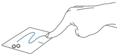
Appuyez deux fois sur un élément et maintenez votre doigt sur le pavé tactile en le faisant glisser jusqu'à l'endroit voulu. Désengagez votre doigt du pavé tactile pour placer l'objet à l'endroit voulu.
