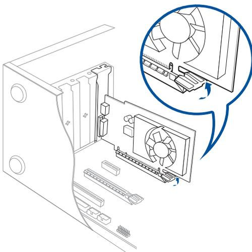
6. Utilisez un tournevis et une vis pour fixer la carte graphique sur le châssis.
