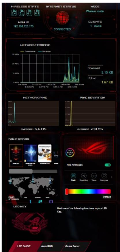
Le ping de réseau fait référence aux expériences de jeu en ligne. Plus le ping est élevé plus la latence est élevée pour les jeux en temps réel. Un ping de réseau inférieur à 99 ms est considéré comme de bonne qualité pour la plupart des jeux en ligne. Si le ping de réseau est inférieur à 150 ms, la qualité est considérée comme acceptable. En général, si le ping de réseau est supérieur à 150 ms, il est difficile de pouvoir jouer de manière fluide.
