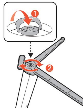
Orientez et alignez le bras du support avec le moniteur, puis poussez pour les rapprocher jusqu'à un déclic et leur verrouillage en place.
