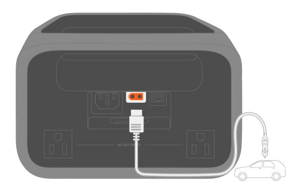
Pour éviter que le véhicule ne puisse pas démarrer en raison d'une batterie insuffisante, démarrez d'abord le véhicule avant de commencer la charge. Assurez-vous également que le câble de charge est correctement connecté à la prise allume-cigare.
