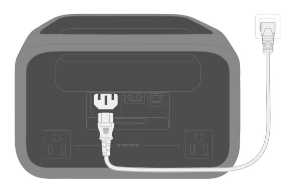
Il est recommandé d'utiliser une prise de courant d'une capacité supérieure à 10 A et de vérifier que son courant de fonctionnement reste constamment audessus de ce seuil.
