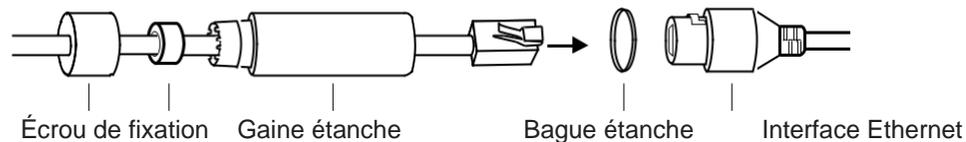
1. Acheminez le câble réseau à travers les composants suivants dans l'ordre : écrou de fixation, bague étanche, puis la gaine étanche.
