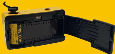
Assurez-vous que le film repose à plat contre le centre de la caméra et fermez la porte arrière de la caméra.
