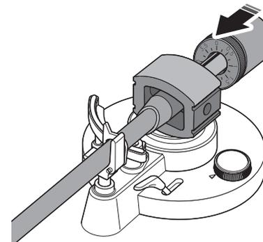
**8 Присоедините каркас головки к тонарму.**
