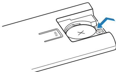
**3** Insérez la pile et remettez le couvercle en place en le faisant glisser dans le sens de la flèche.
