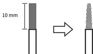
**2 Tournez le bouton de la prise d'enceinte vers la gauche pour le desserrer, puis insérez l'âme du câble d'enceinte dans l'orifice de la prise.**
