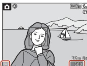
Indicateur du niveau de charge de l'accumulateur
