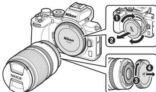
2. Placez l'objectif sur le boîtier de l'appareil photo, en maintenant le repère de montage de l'objectif aligné sur le repère de montage du boîtier de l'appareil photo (1), puis faites pivoter l'objectif dans le sens inverse des aiguilles d'une montre (2) jusqu'au déclic.
