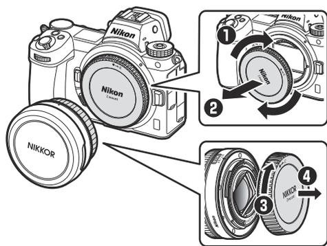
**2. Placez l'objectif sur le boîtier de l'appareil photo, tout en gardant le repère de montage de l'objectif aligné sur celui du boîtier de l'appareil photo (①), puis tournez l'objectif dans le sens indiqué (②) jusqu'à ce qu'il s'enclenche.**
