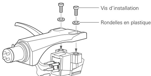
6. **À l'aide d'un tournevis fendu non métallique vendu dans le commerce, serrez les vis dans les deux emplacements, puis ajustez l'overhang.**
