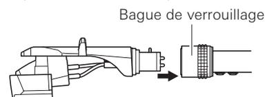
3. Une fois le porte-cellule inséré, tournez la bague de verrouillage dans le sens antihoraire (vers la gauche).
