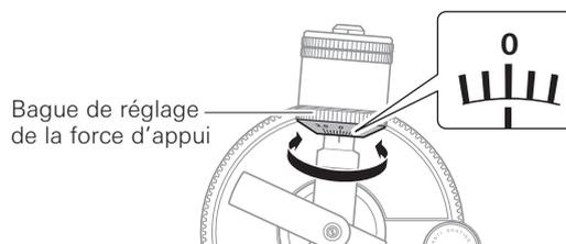
2. Tournez le contrepois et la bague de réglage de la force d'appui dans le sens antihoraire (vers la gauche) jusqu'à ce que la valeur de la ligne centrale corresponde à la valeur de la force d'appui pour la cellule utilisée.
