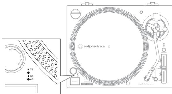
3. Si vous appuyez sur le bouton QUARTZ, le verrouillage à quartz interne maintiendra le plateau à une vitesse nominale précise, quelle que soit la position du curseur de réglage du pitch.
