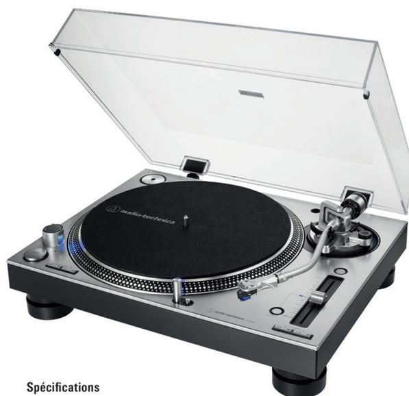
La platine professionnelle AT-LP140XP, entièrement manuelle, comprend un moteur à entraînement direct avec un couple élevé, un plateau moulé en fonte d'aluminium, amorti et anti résonnant afin d'assurer une rotation stable dans l'axe (à 33 $\frac{1}{3}$ , 45 et 78 tours/minute). Elle est équipée d'un bras de lecture en forme de S avec réglages de la hauteur, de la force d'appui et le contrôle dynamique de l'anti-skating.
