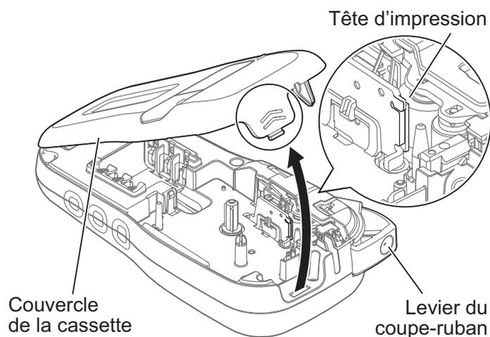
Avec l'écran LCD tourné vers le bas, ouvrez le couvercle de la cassette en appuyant sur la patte rainurée et en poussant le couvercle dans le sens de la flèche, comme indiqué dans l'illustration.
