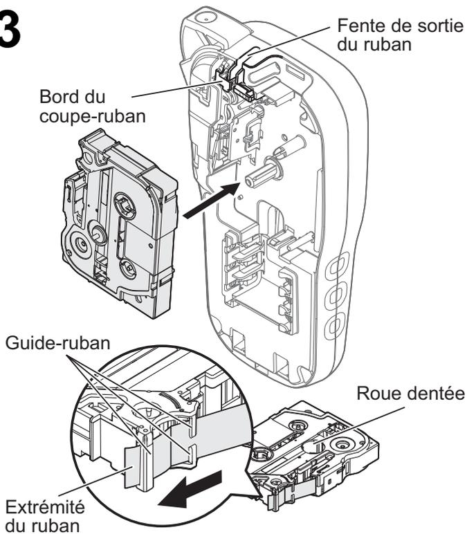
**Insérez la cassette à ruban en suivant le dessin à l'intérieur du boîtier. Appuyez délicatement sur la cassette jusqu'à ce qu'elle s'enclenche dans l'étiqueteuse P-touch.**
