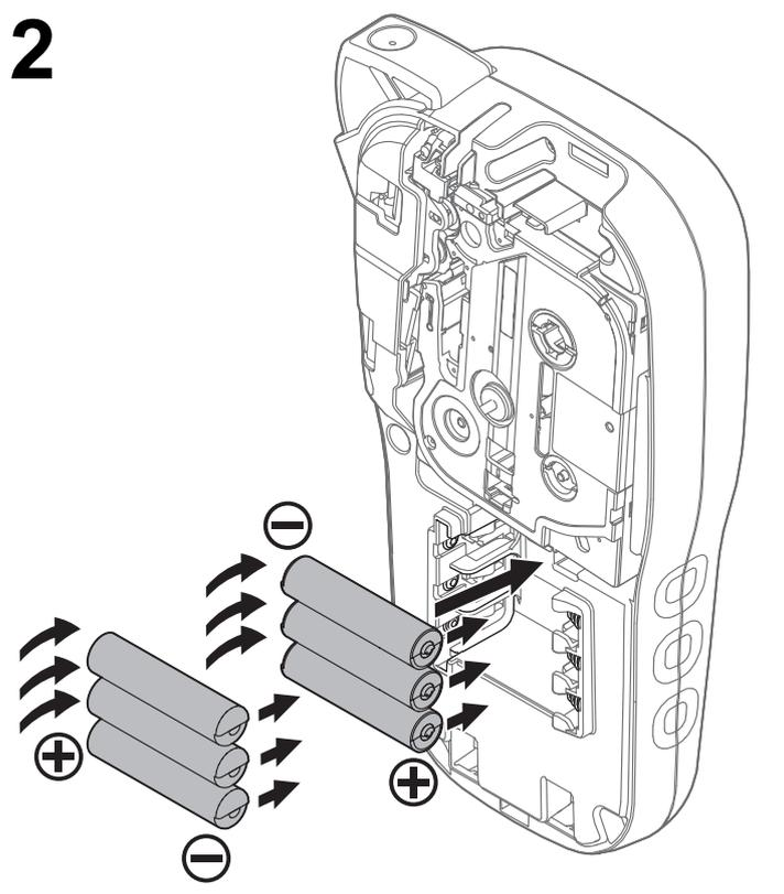
Avant de remplacer les piles ou la cassette à ruban, assurez-vous que l'appareil est éteint. Cette étiqueteuse P-touch requiert six piles alcalines AAA ou six piles Ni-MH complètement rechargées (non incluses).
