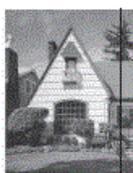
Lorsque la bande de verre est souillée par de la saleté ou du liquide correcteur, une ligne verticale apparaît sur l'échantillon imprimé.
