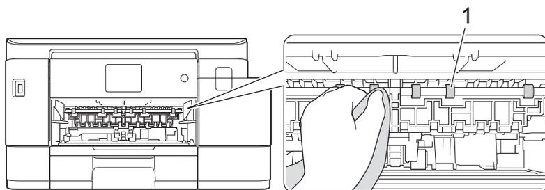
6. Soulevez le couvercle (2), puis nettoyez l'arrière des rouleaux d'alimentation du papier (1) avec un chiffon doux non pelucheux humecté d'eau. Une fois le nettoyage terminé, essuyez les rouleaux avec un chiffon doux, sec et non pelucheux pour éliminer les traces d'humidité.
