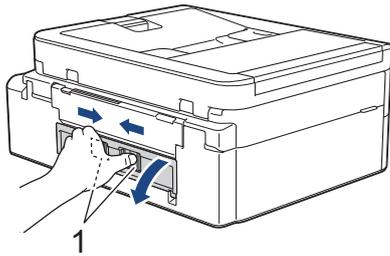
(MFC-J4540DW) Ouvrez le couvercle d'élimination du bourrage (1) à l'arrière de l'appareil.
