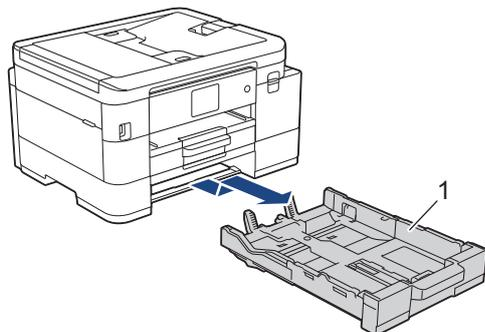
4. Nettoyez les rouleaux d'entraînement du papier pour le bac n° 2 (1) avec un chiffon doux non pelucheux humecté d'eau. Tournez lentement les rouleaux afin que la surface tout entière soit nettoyée. Une fois le nettoyage terminé, essuyez les rouleaux avec un chiffon doux, sec et non pelucheux pour éliminer les traces d'humidité.
