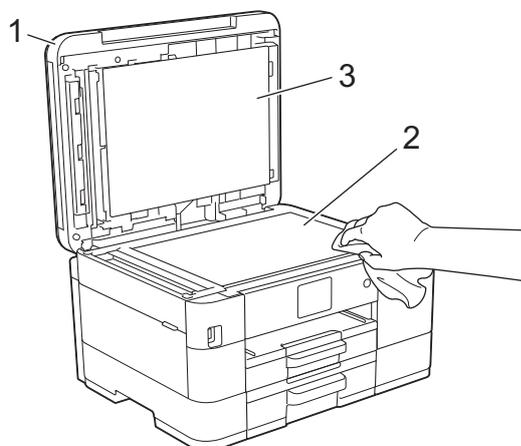
3. Dans le chargeur, nettoyez la barre blanche (1) et la bande en verre (2) à l'aide d'un chiffon doux non pelucheux, humidifié avec de l'eau.
