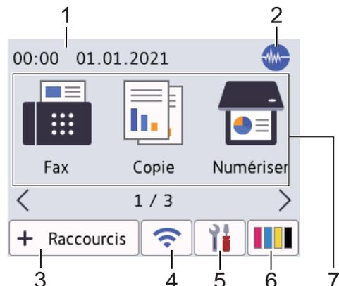
Cet écran affiche l'état de l'appareil lorsque ce dernier est inactif. Lorsqu'il est affiché, cet écran indique que l'appareil est prêt pour la commande suivante.
