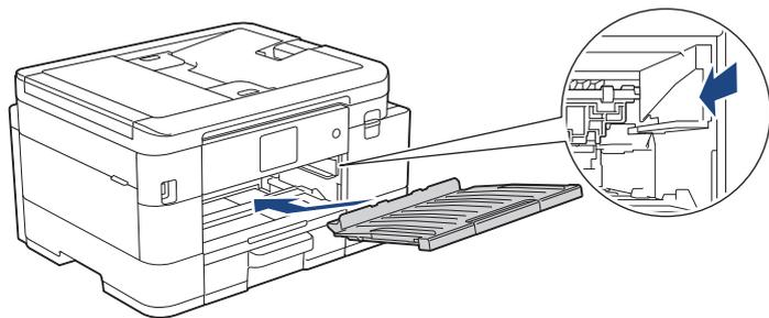
9. Poussez lentement le bac n° 1 pour l'insérer complètement dans l'appareil.
