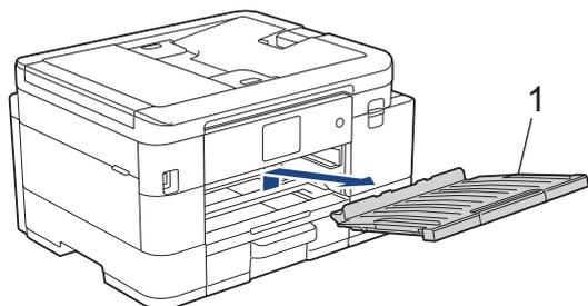
5. Nettoyez les rouleaux d'entraînement du papier (1) avec un chiffon doux non pelucheux humecté d'eau. Tournez lentement les rouleaux afin que la surface tout entière soit nettoyée. Une fois le nettoyage terminé, essuyez les rouleaux avec un chiffon doux, sec et non pelucheux pour éliminer les traces d'humidité.
