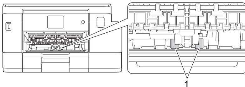
6. Remettez fermement le support papier dans l'appareil. Assurez-vous que le support papier est bien installé dans les rainures.
