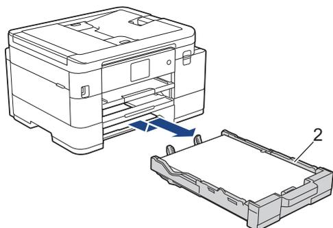
3. Si le message d'erreur [Bourrage arrière] s'affiche sur l'écran LCD, soulevez le support papier (1), puis tirez-le perpendiculairement pour le sortir complètement de l'appareil comme indiqué par la flèche.
