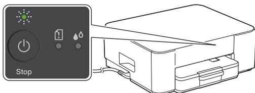
L'appareil se met automatiquement sous tension et la LED d'alimentation commence à clignoter.
