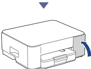
Après avoir installé les quatre réservoirs d'encre, fermez le couvercle des cartouches d'encre. L'appareil lance le nettoyage initial du système d'encre.
