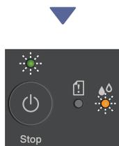
Pendant le nettoyage initial, les LED d'alimentation et d'encre clignotent toutes les deux. Le nettoyage peut durer plusieurs minutes. L'appareil peut être silencieux pendant les deux premières minutes, le temps que les réservoirs d'encre se remplissent.
