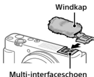
Gebruik de windkap om het windgeruis te verminderen dat wordt opgevangen door de ingebouwde microfoon tijdens het opnemen van bewegende beelden. Bevestig de windkap op de multi-interfaceschoen.
