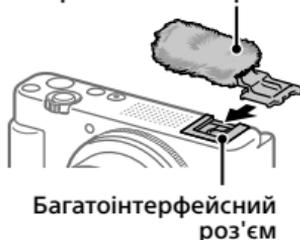
Використовуйте вітрозахисний екран для усунення шуму вітру, що записується внутрішнім мікрофоном під час відеозйомки. Під'єднайте вітрозахисний екран вітру до багатоінтерфейсного роз'єму.
