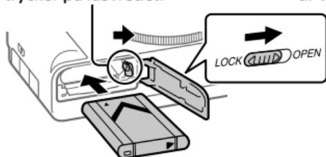
Kontrollera att det fasade hörnet är vänt åt rätt håll.
