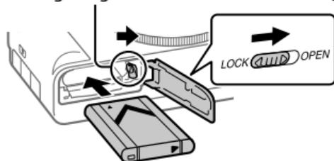
Auf korrekte Ausrichtung der abgeschnittenen Ecke achten.
