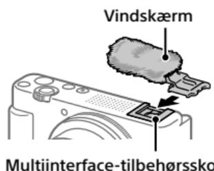
Brug vindskærmen til at reducere den vindstøj, som opfanges pga. den interne mikrofon, når du optager en film.
