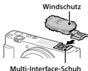
Verwenden Sie den Windschutz, um Windgeräusche zu reduzieren, die während einer Filmaufnahme vom internen Mikrofon aufgenommen werden.
