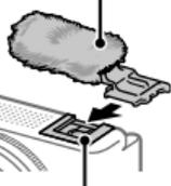
Ochranu pred vplyvom vetra použite na zamedzenie hluku vetra snímaného vnútorným mikrofónom pri snímaní videozáznamu.
