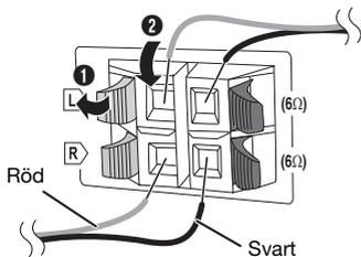
Var försiktig så att du inte korsar (kortsletter) eller kastar om polariteten på högtalarkablarna eftersom detta kan skada högtalarna.
