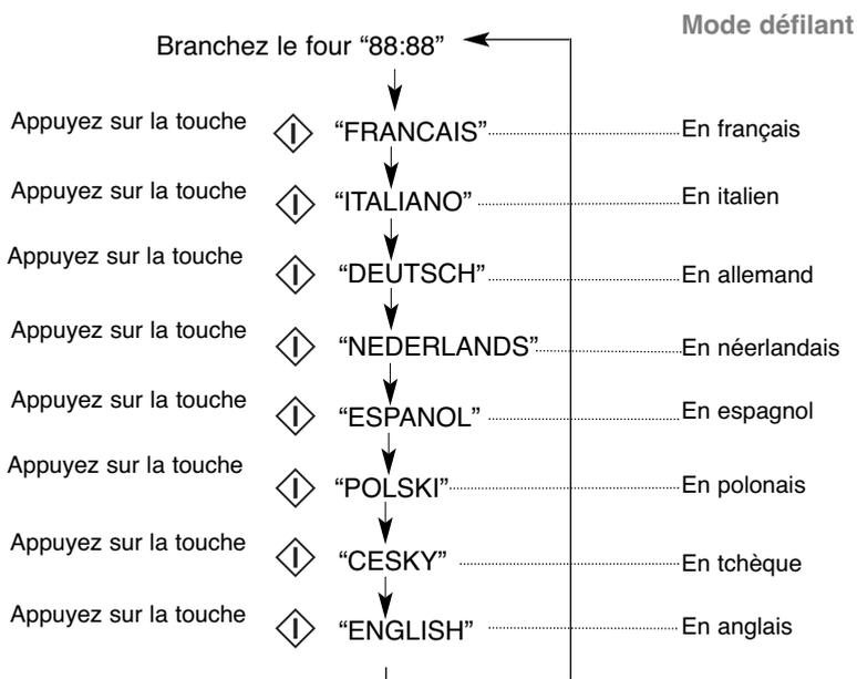
Ce modèle a une fonction unique. Il est équipé d'un mode défilant qui vous aide à l'utiliser. Après avoir branché le four, appuyez sur la touche Marche (START) à plusieurs reprises, jusqu'à ce que la langue souhaitée soit sélectionnée. Au fur et à mesure que vous appuyez sur les touches, l'affichage fait apparaître l'instruction suivante pour vous éviter de commettre des erreurs. Si, pour une raison quelconque, vous souhaitez changer de langue, débranchez le four et répétez cette procédure.
