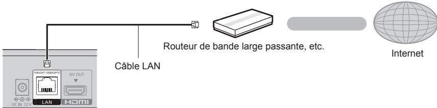
Utilisez des câbles LAN droits de catégorie 5e ou supérieure (STP) pour connecter les appareils périphériques.
