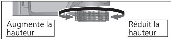
Soulever le tourne-disque pour tourner les isolateurs et régler la hauteur.
