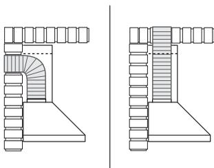
Der Höchstabstand von der Kanalisation soll bei einer 90° Krümmung 3 Meter betragen. Für jede zusätzliche 90° Krümmung verringert sich der Höchstabstand um einen Meter. Bei fehlerhafter Kanalisation nimmt die Geräusentwicklung zu und die Leistungen nehmen ab.
