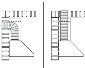
De maximale afstand van de pijpleiding moet 3 meter zijn met een bocht van 90 graden.
