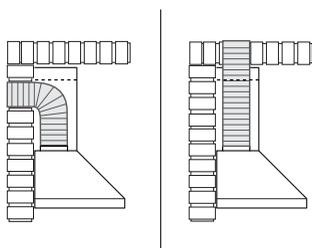
La distance maximum de la canalisation devrait être de 3 mètres avec un coude à 90 degrés. Pour chaque coude à 90 degrés supplémentaire, la distance maximum se réduit de 1 mètre. Si la canalisation n'est pas correcte, il y aura une augmentation du bruit et une diminution des performances.
