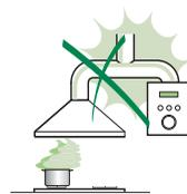
Relier l'aspirateur au conduit de cheminée avec un tube d'un diamètre minimum de 120 mm. Le parcours des fumées doit être le plus court possible.
