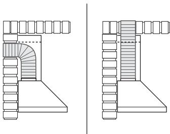
La distancia máxima de la canalización debe ser de 3 metros con una curva de 90 grados.
