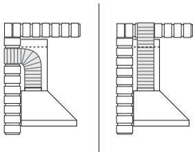
La distanza massima della canalizzazione dovrebbe essere di 3 metri con una curva di 90 gradi.
