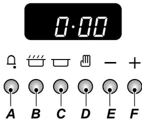
A - Minuterie, B - Temps de « cuisson », C - Temps « d'arrêt », D - Manuel, E & F - Boutons de réglage de l'heure
