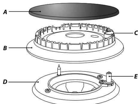
A – Bouchon, B – Tête, C – Encoche, D – Base, E – Électrode
