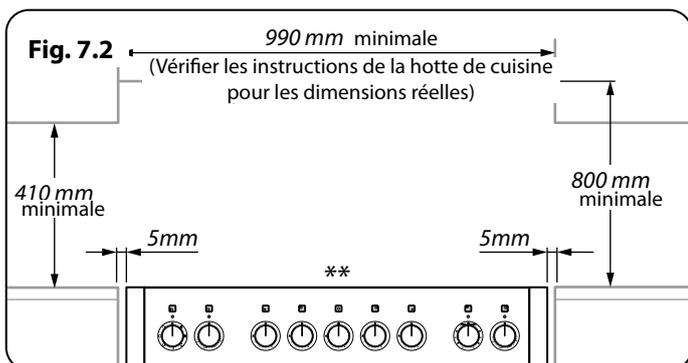
Les surfaces des meubles et des murs de chaque côté et à l'arrière de l'appareil doivent être résistantes à la chaleur, aux éclaboussures et à la vapeur. Certains types de meubles de cuisine en vinyle ou en stratifié sont particulièrement susceptibles aux risques de dommages thermiques et de décoloration.
