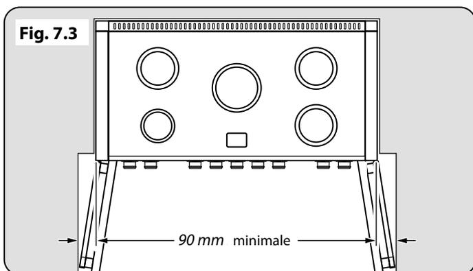
Si la cuisinière est près d'un coin de la cuisine, un dégagement de 90 mm est nécessaire pour permettre l'ouverture des portes de fours (**Fig. 7.3**). La cote d'ouverture des portes est légèrement inférieure à ce dégagement, mais ceci inclut une marge de sécurité pour la protection des mains lors de l'ouverture de la porte.
