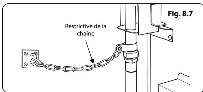
Si vous utilisez une chaîne de stabilisation (**Fig. 8.7**), la chaîne devra alors être aussi courte que possible et fixée fermement à l'arrière de la cuisinière.
