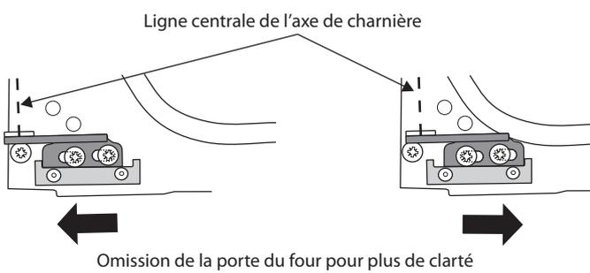
Vérifiez que le joint d'étanchéité de la porte n'est pas endommagé et que le loquet de porte est réglé de façon à ce que la porte soit bien appuyée contre le joint.
